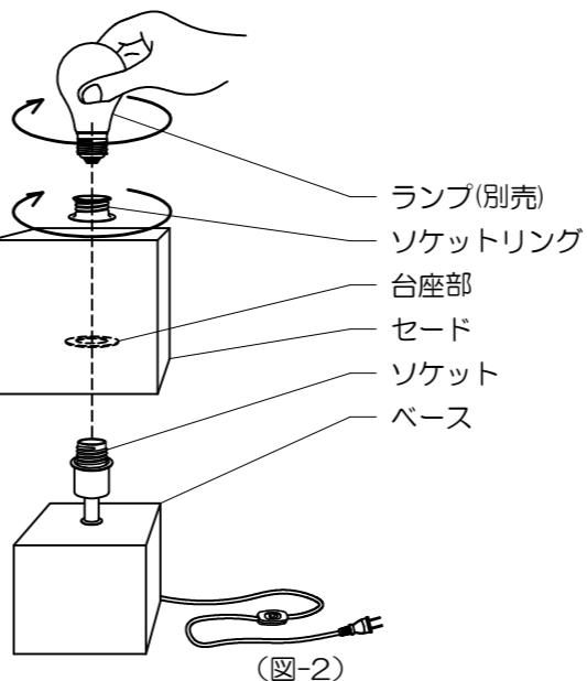
2. セードの台座部にソケットを通し、ソケットリングで固定します。（図-2）
