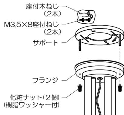
2.化粧ナット（2個）をはずして、フランジからサポートをはずしてください。サポートに座付木ねじ、M3.5×8座付ねじがテープ止めされています。
