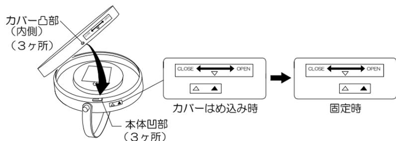
⑤カバー内側の凸部を本体側の凹部に合わせ、時計回りに固定します。
